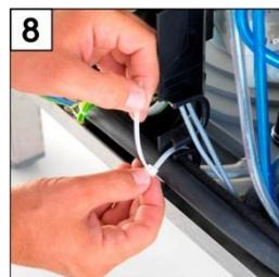
8 Para aliviar a carga de tracção, fixar o cabo de ligação à rede eléctrica com um atilho à placa de montagem.
