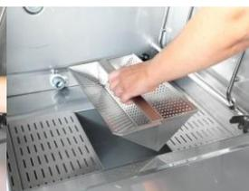
Extraiga el cilindro de filtro y los filtros de superficie.
