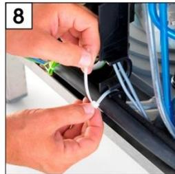
8 Fije el cable de conexión con un conector a la placa de montaje.
