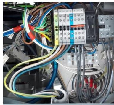
Collegare il cavo di alimentazione ai morsetti da PE a N, conformemente allo schema di collegamento.
