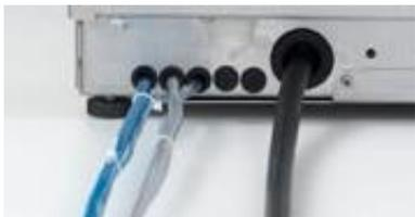
Introdurre il cavo di alimentazione nel pannello posteriore della macchina e portarlo davanti dove si trovano i morsetti di collegamento.
