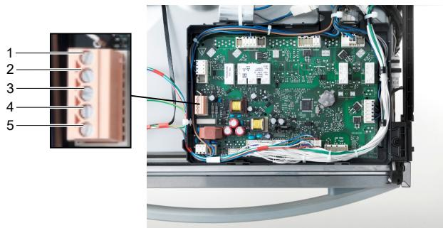
**Nota: Consumo de corrente máxima na régua de transmissão: 0,5 A. Ligue apenas doseadores externos com disjuntor (proteção de fusível) próprio. Integre o doseador no sistema condutor de proteção de terra (PE) da máquina de lavar.**
